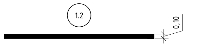
1. Обозначение границы разделения велосипедной и пешеходной дорожек на велопешеходной дорожк
